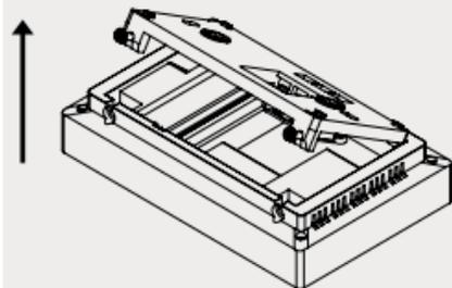
Inserire 2 batterie tipo AA da 1,5V nell'apposito vano seguendo le indicazioni sulla polarità;
