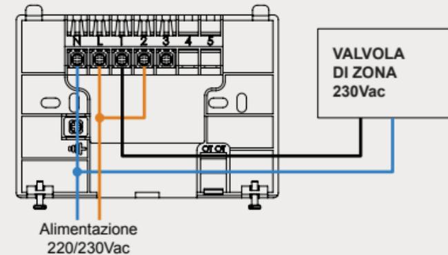
**ATTENZIONE:** il grafico di collegamento illustrato rappresenta solo uno dei collegamenti possibili. Per l'installazione rivolgersi ad un tecnico qualificato. In caso di dubbi è possibile contattare l'assistenza plikc.
